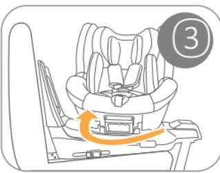
1. Naciśnij przycisk obrotu z boku dolnej części, jednocześnie obracając skorupę fotelika o  $90^{\circ}$  w kierunku drzwi pojazdu.
