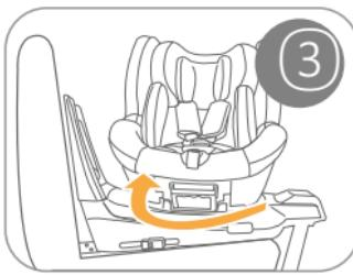
1. Stiskněte tlačítko otáčení na boční spodní části a otočte skořepinu autosedačky o  $90^{\circ}$  směrem ke dveřím vozidla.
